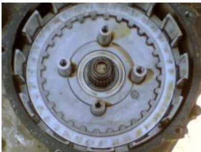
Bild 15: äußerer Teil mit Druckplatte
