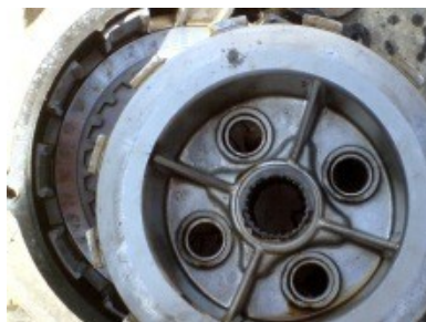
Bild 12: Kupplung ohne Druckplatte
