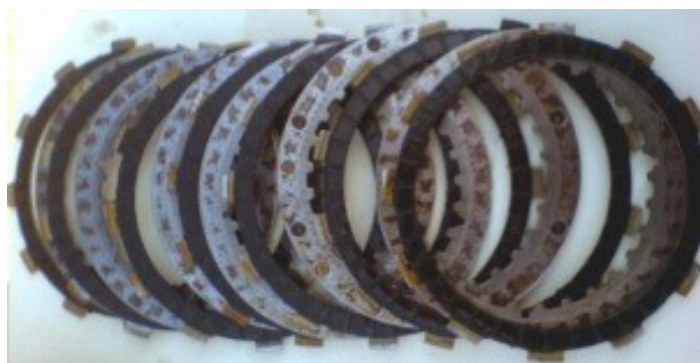
Bild 14: Kupplungsplatten und -scheiben
