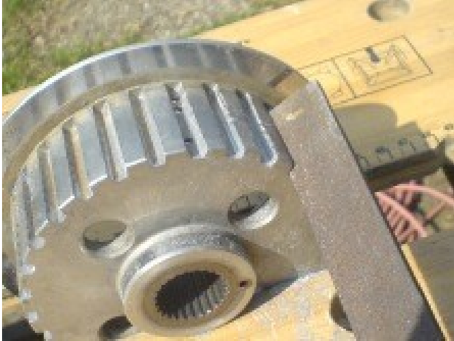
Bild 18: Ausfeilen der inneren Kupplungsnahe
