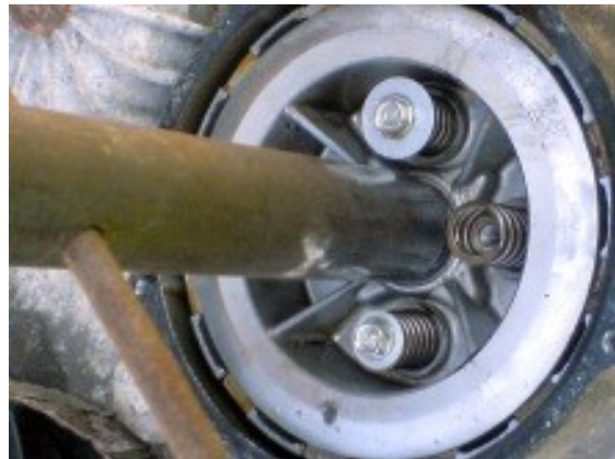
Bild 9: Nutmutter (=Kontermutter) lösen
