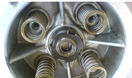
Bild 8: Federn und Nutmutter im Innenkorb
