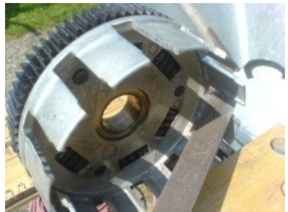
Bild 19: äußere Kupplungsnahe ausfeilen
